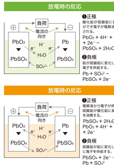
蓄電池は化学反応によって直流電気の充放電を行っています。参考までに鉛蓄電池の化学反応の様子を記します。
