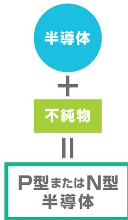
この2つを接合し(PN接合といいます)接合面に光を当てると電気が流れます。これを光起電力効果と呼び、太陽光発電はこの現象を利用しています。グラウンドモデルで使用されているCIS結晶はP型半導体部に使用され、N型に用いられる酸化亜鉛の薄膜電極とのPN接合に光が当たると電気が流れます。また良質なCIS吸光層を形成するためPN層の間に亜鉛化合物のバッファ層が形成されています。
