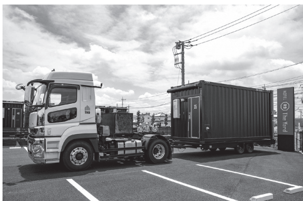
基礎と分離させ、陸路・海路などを使い容易に客室を移設できる〈写真提供：(株)デベロッパ〉
